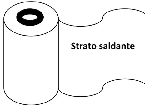
Figura 1. Disposizione dello strato saldante del film AMISTYLE
